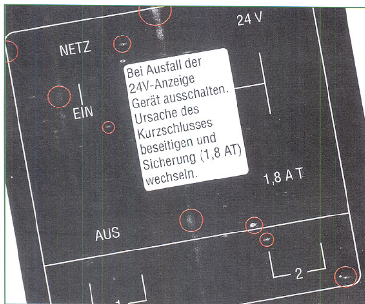
Bild 5: Blackout andersherum: Bei ungünstigen Bedingungen können bei großen Schwarzflächen Ausfälle entstehen - das Material ist vergeudet.
